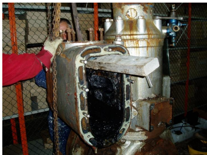
Her er endelukkene til lyd-potta tatt av, og potta forberedes å bli demotert fra sylindren. Mye graps å ta ut herfra.
