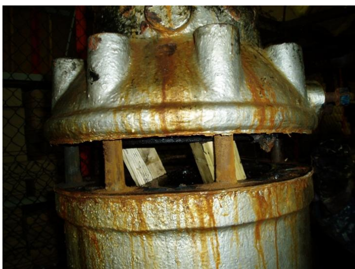
En kjent måte fra gamle dager å få løsnet toppen på, spesielt på slike motorer, er å få lagt inn noen fremmedelementer på stempeltoppen, og så benytte "tørnemetoden" på å dytte toppstykket oppover med stempelet.
